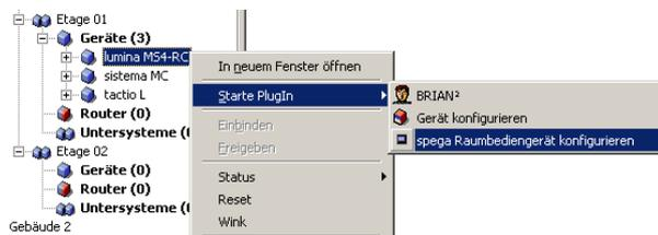
Das Geräte Plug-in wird über das entsprechende Gerät gestartet.
