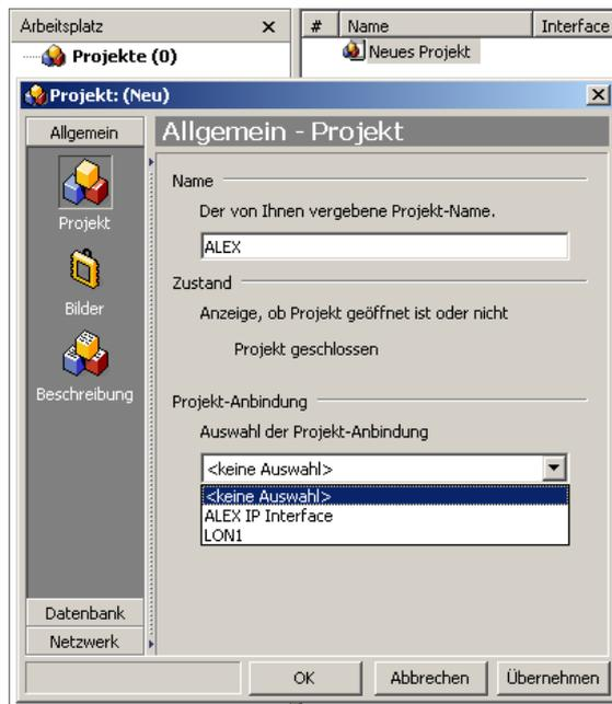
Hier wird der Name des Projekts vergeben. Die Projekt-Anbindung (LON-Schnittstelle) kann bereits zugewiesen werden.
