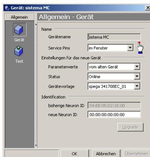
Hierbei wird die Neuron-ID des neuen Geräts der Datenbank zugewiesen. Die Übertragung der Neuron-ID kann auch hier mit dem Service-Pin oder über die Eingabe in das Feld „Neuron-ID“ erfolgen. Alle Konfigurationseinstellungen und Verbindungen des alten Geräts werden übernommen und dem neuen Gerät zugewiesen.
