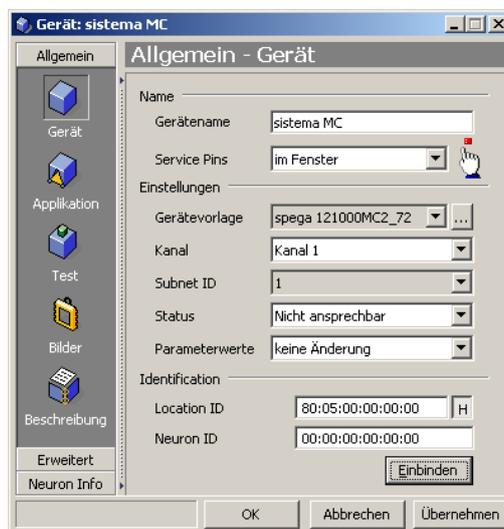
Zum Kommissionieren muss den Geräten die jeweilige Neuron-ID zugewiesen werden. Dies kann durch Eintragen in das Feld „Neuron-ID“ oder durch Betätigen des Service-Pins am Gerät erfolgen. Es ist darauf zu achten, dass die Zuordnung des Kanals mit dem physikalischen Anschluss des Geräts übereinstimmen muss.
