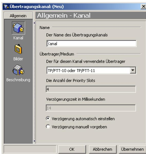
Hier wird der Name des Kanals vergeben. Weiterhin ist der Mediumtyp einzustellen. Für einen FT\_Kanal ist „TP/FTT-10“ zu wählen. Für einen LON/IP-Kanal ist „IP-10L“ einzustellen.
