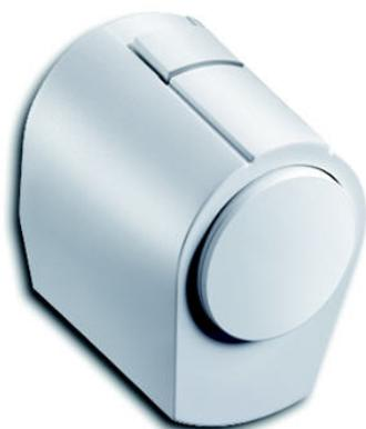
Die Stellantriebe clima A24-10AC und clima A24-10DC sind geräuschlose und wartungsfreie, stetige elektrothermische Stellantriebe, die für den Anschluss an clima RCM-CC, clima RO-CC, clima AA4-10V, clima AA8-10V, clima FCB-10V oder clima DL-110 geeignet ist. Das Stellsignal ist ein 0-10V Analogsignal, entweder als Gleichstrom oder Wechselstromsignal, je nach Auslegungsvariante.
