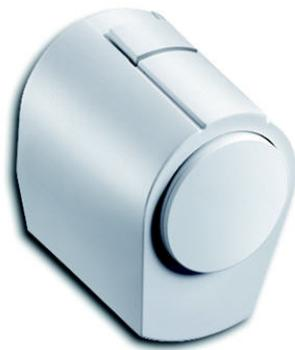
Der Stellantrieb A24-T ist ein geräuschloser und wartungsfreier stetiger elektrothermischer Stellantrieb, der zum Beispiel für den Anschluss an clima FCB-24 oder clima AA4 und clima AA8 Aktorik geeignet ist.
